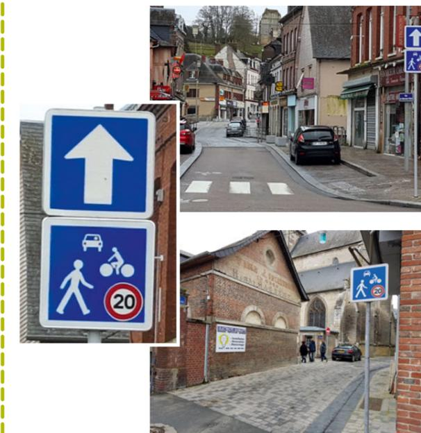
À noter, le sens de la circulation des vélos se fait en sens inverse de celui des voitures, un marquage au sol permet de rappeler ce cheminement. Avec une limitation de vitesse à 20km/h maximale. L'objectif est de permettre une conciliation entre les différents modes de transport, un partage de l'espace. Un espace partagé au cœur du centre-ville.
